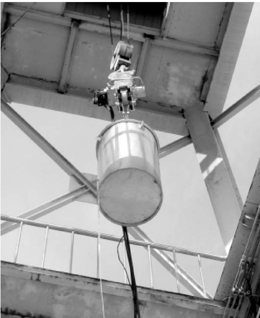
Fig. 7. Free drop test rig.
